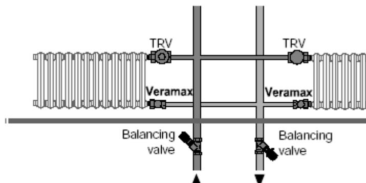
Рис. 4. Пример установки.
